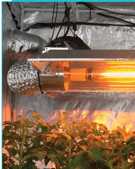
Az izzó által termelt hő hatékony elvezetése Cool Tube reflektor használatával
