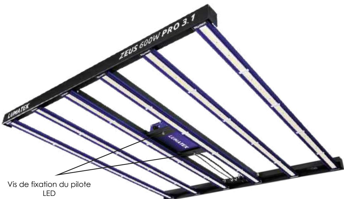
Le pilote LED est fixé au support de montage à l'aide de deux vis de retenue qui traversent le support pour aller dans la plaque de base du pilote. Pour une plus grande flexibilité, le driver peut être déconnecté de l'appareil et utilisé à distance à l'aide des câbles d'extension du pilote LED Lumatek de 5m (vendus séparément).
