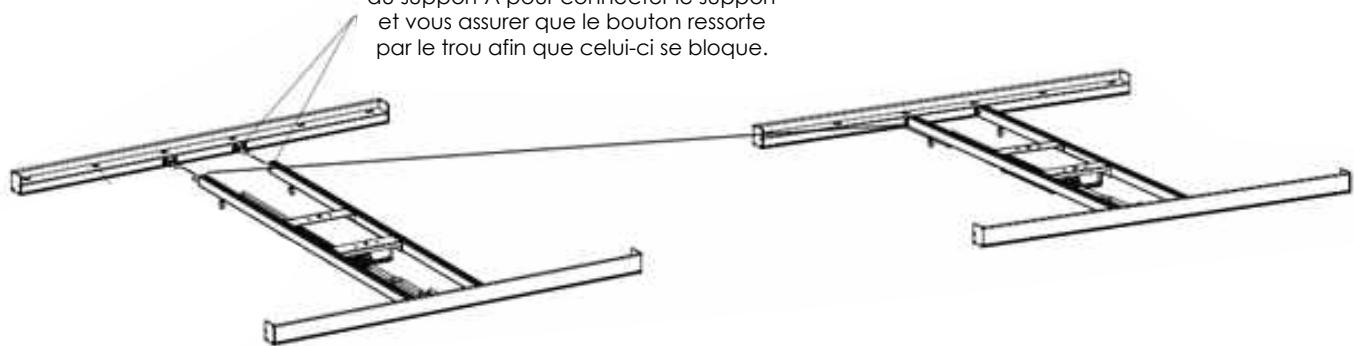
**Vérifiez sa direction lors de l'installation; le support du transformateur doit se trouver au-dessus lorsque la lampe est suspendue.**
