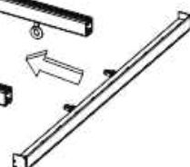
**Notez la direction lors de l'installation ; le support de montage du pilote LED est en haut lorsque le luminaire est suspendu.**
