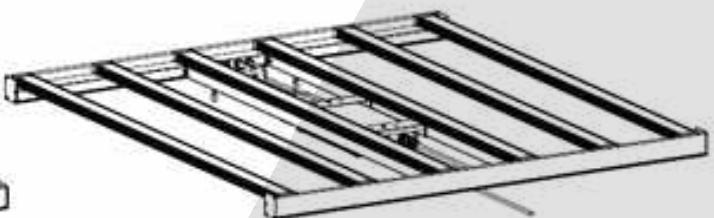
Assemblare il resto delle barre luminose nel telaio di fissaggio come mostrato in Figura
