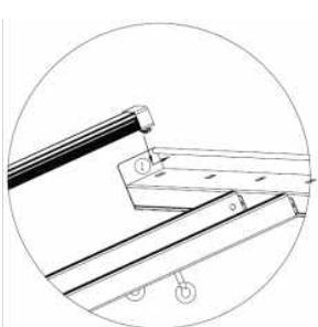
l'autre bout; alignez le trou rond du support B avec le bout magnétique de la lampe et insérez le pin mâle dans la fiche femelle. Assurez-vous que la liaison magnétique soit sécurisée.
