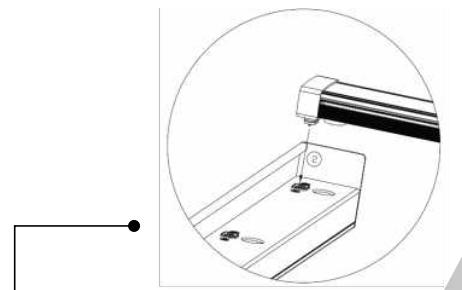
l'altra estremità; allineare il foro rotondo del telaio B con l'estremità magnetica della barra luminosa e inserire il perno maschile nella presa femmina. Assicurarsi che il collegamento magnetico sia sicuro.
