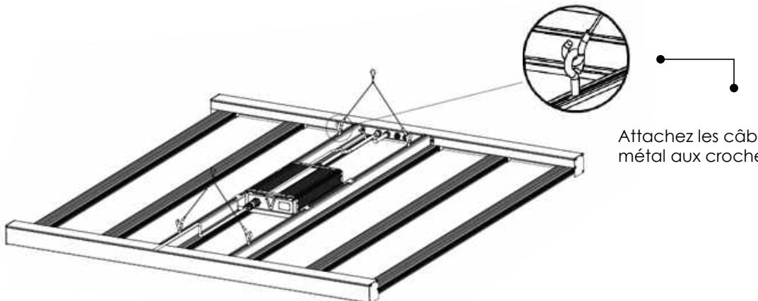
Attachez les câbles d'attache en métal aux crochets de montage.
