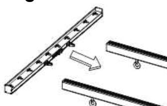
Connectez le cadre B à l'extrémité du cadre de support près de la sortie d'alimentation du pilote LED et des connecteurs femelles de gradation.
