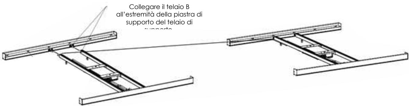
Premere il pulsante sul connettore push-click del telaio A per collegare al telaio di supporto e assicurarsi che il pulsante scatti nella cavità per serrare. Fare attenzione alla direzione durante l'installazione; il vassoio del driver risulta in alto quando l'apparecchio è appeso.
