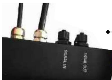
Připojte kabel ručního stmívače nebo kabel ovladače osvětlení k portu SIGNAL IN.
