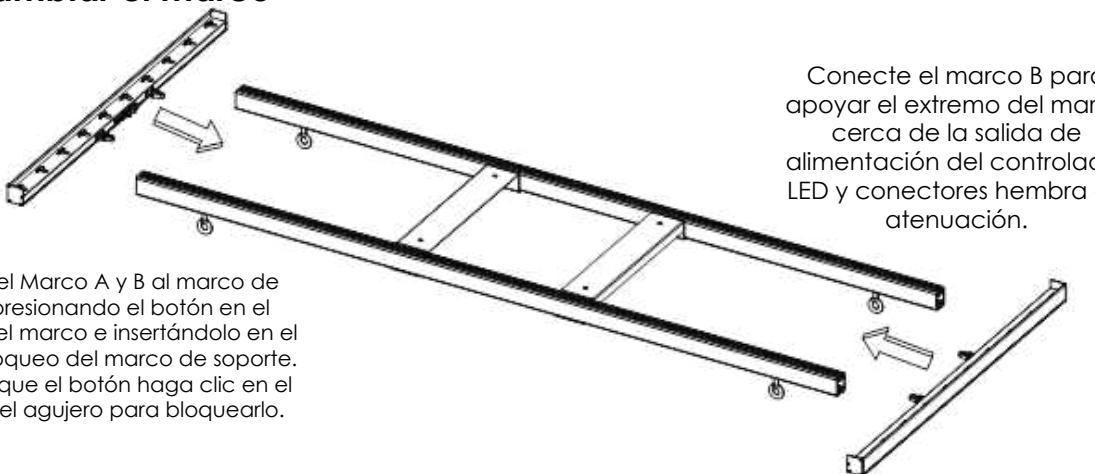
Conecte el marco B para apoyar el extremo del marco cerca de la salida de alimentación del controlador LED y conectores hembra de atenuación.
