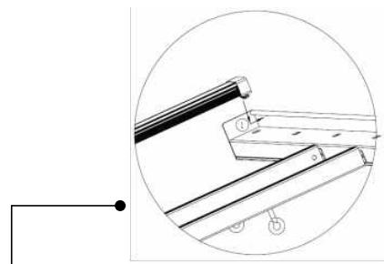
Assicurarsi che il driver sia stabile e capovolgere l'apparecchio in modo che il driver si trovi in posizione inferiore. Inserire l'estremità della barra luminosa con il gancio nel foro quadrato nel telaio A
