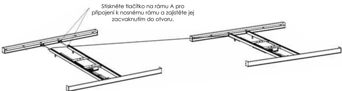
Při instalaci si všimněte směru; při zavěšení svítidla je příhrádka na řidič nahoře.
