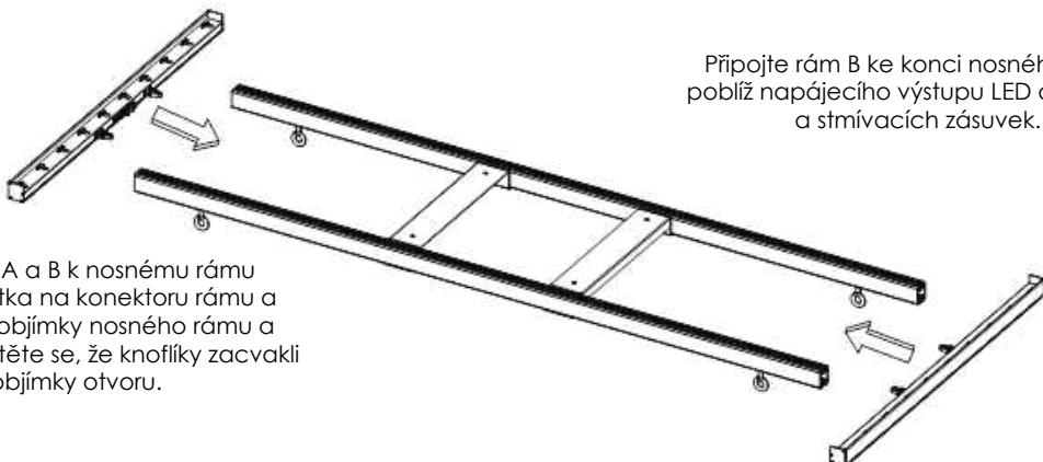
Připojte rám A a B k nosnému rámu stisknutím tlačítka na konektoru rámu a zasunutím do objímky nosného rámu a uzamknutím. Ujistěte se, že knoflíky zacvakli do objímky otvoru.
