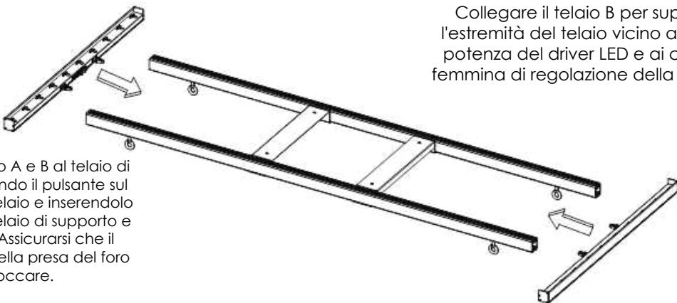
Collegare il telaio A e B al telaio di supporto premendo il pulsante sul connettore del telaio e inserendolo nella presa del telaio di supporto e bloccandolo. Assicurarsi che il pulsante scatti nella presa del foro per bloccare.
